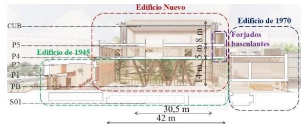
Figura 3. Sección transversal (fuente: F+P).
