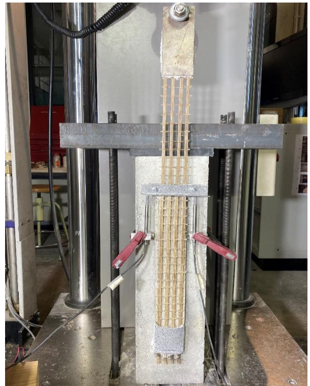
Figura 8. Modo de fallo de ensayos de adherencia con textil de cáñamo HE y mortero convencional.
