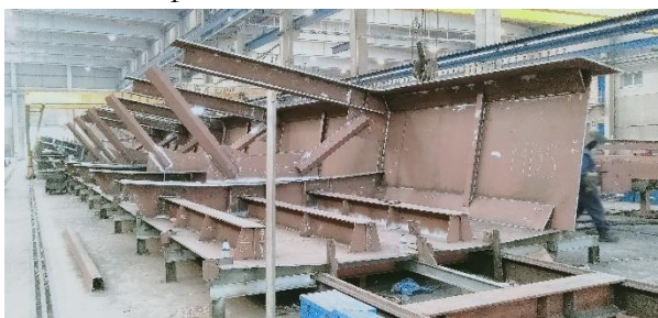
Figura 5. Fabricación de un subconjunto del tablero.
