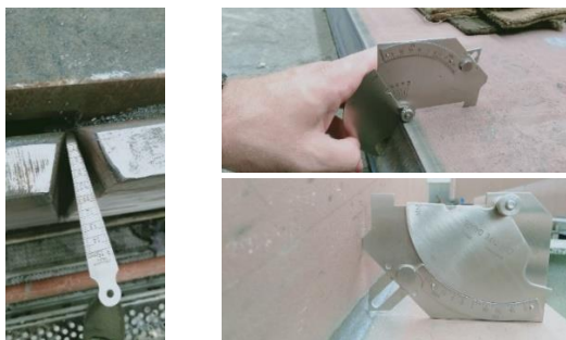
Figura 23. Control geométrico en uniones.
