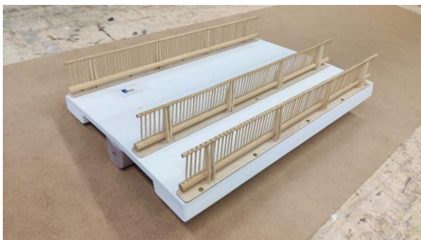
Figura 10. Modelo seccional de los ensayos estáticos.
