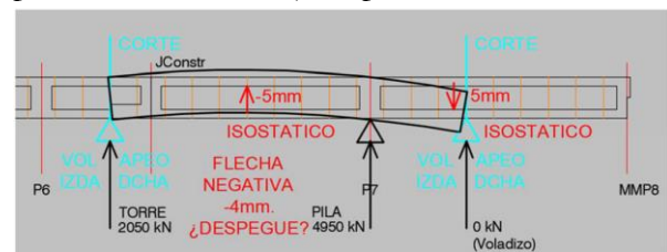
Figura 6. Esquema de división del tablero mediante cortes principales.
