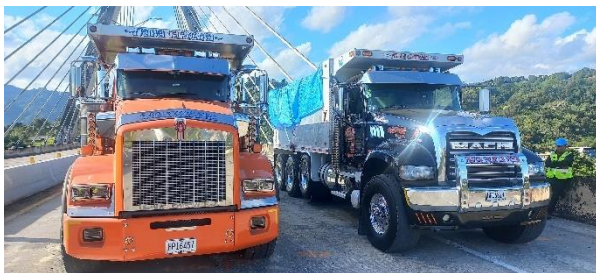
Figura 6. Vista de la prueba de carga estática
