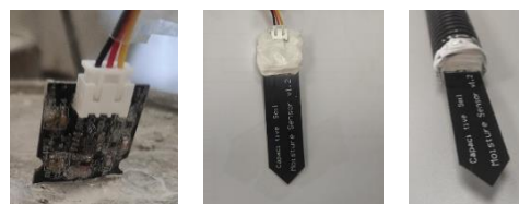
Figura 1. Impermeabilización del sensor de humedad con: a) cola silicona de uso general, b) con cola de silicona neutra y c) tubo PVC.
