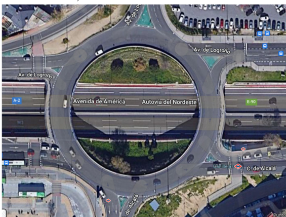
Figura 22. Longitud de estructura de \approx 35\text{m} sin posibilidad de dar continuidad a los extremos.
