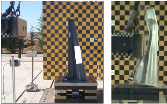
Figura 16. Ensayo de péndulo para determinación de los esfuerzos máximos transmitidos por un pretil [4]
