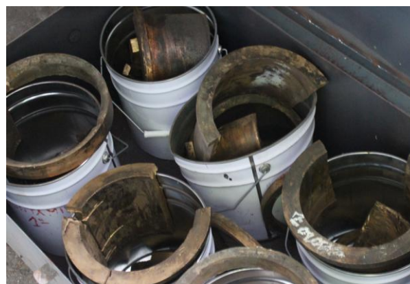
Figura 16. Casquillos originales del puente (bronce)
