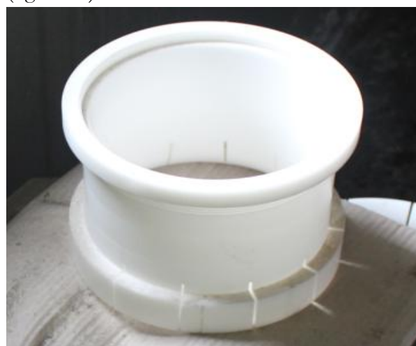
Figura 15. Casquillos fabricados en 2008 (POM-H)
