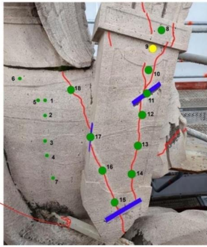
Figura 3. Ejemplo de análisis mediante ultrasonidos. En azul se representan las grapas visibles existentes, en rojo las fisuras y en verde los puntos de medida.
