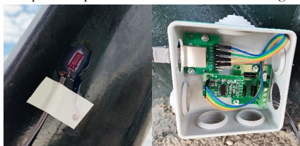
Figura 3: (a) Galga extensiométrica. (b) Circuito electrónico asociado a cada galga.
