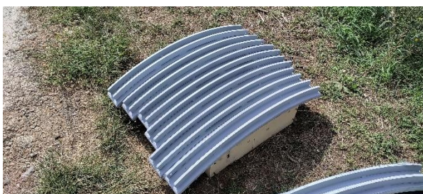
Figura 15. Silla de apoyo de los tirantes en las pilas.
