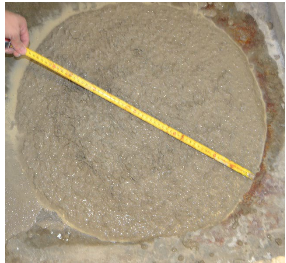
Figura 1: Aspecto visual de ensayo escurrimiento P10.
