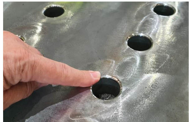
Figura 12. Ejemplo de redondeo de aristas con 2 mm de radio según el código [7], grado P3.
