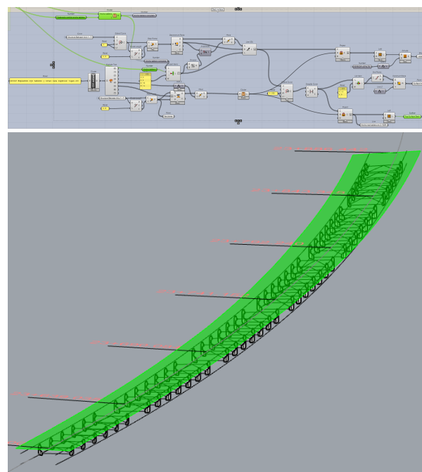
Figura 8. Parte de la programación que genera la superficie de la carretera.
