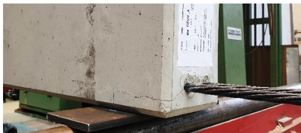
Figura 1. Fisuración superficial en la zona de transferencia del pretensado [8].
