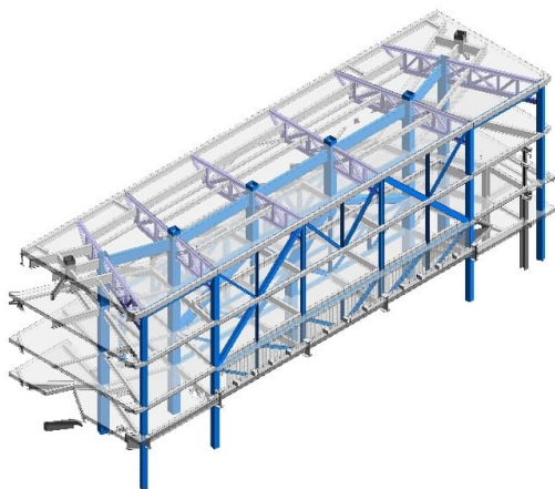
Figura 8. Distribución de celosías tangenciales y radiales
