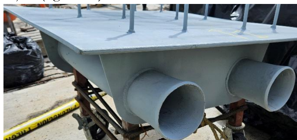
Figura 13. Pieza metálica para desviar los cables d pretensado en el vano central
