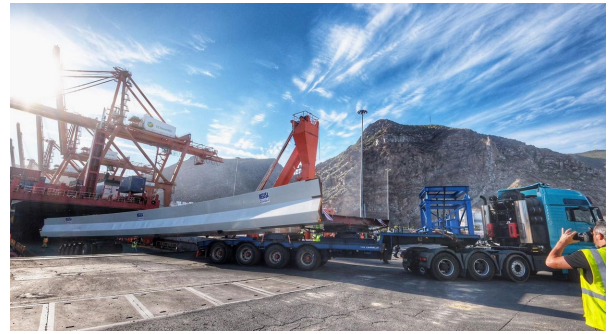
Figura 15. Desembarco de módulo en puerto
