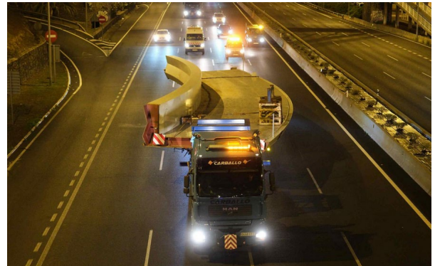
Figura 16. Transporte especial de módulo
