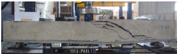
Figura 5. Fotografía de rotura estática (viga con refuerzo de UHPFRC-3%).
