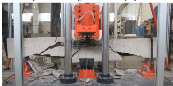
Figura 1. Imagen de un ensayo de impacto de una viga de hormigón armado en la UPM.
