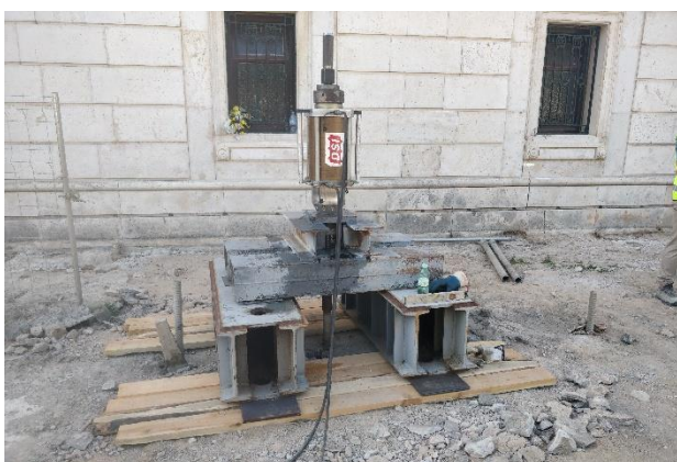
Figura 12. Ensayo de micropilote Ø150 tipo IRS para análisis de desplazamientos reales
