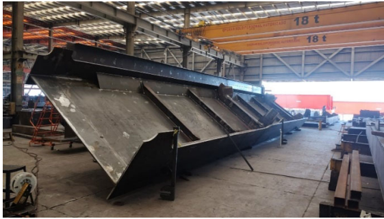
Figura 25. Producción de una semiviga.
