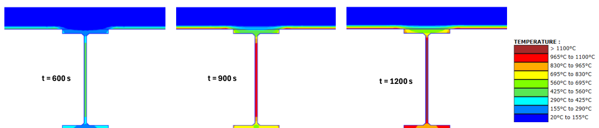
Figura 5. Muestra de resultados del análisis de transferencia de calor para el escenario Trenton 2 utilizando las temperaturas adiabáticas obtenidas con las curvas de fuego paramétricas para la posición relativa X/L = 0.5 .
