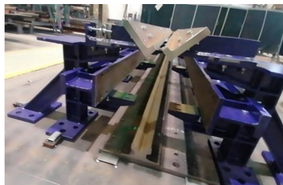
Figura 12. Estructura soporte del motor lineal en taller.
