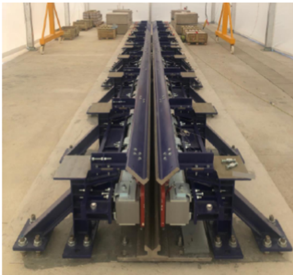
Figura 14. Estructura soporte del motor lineal
