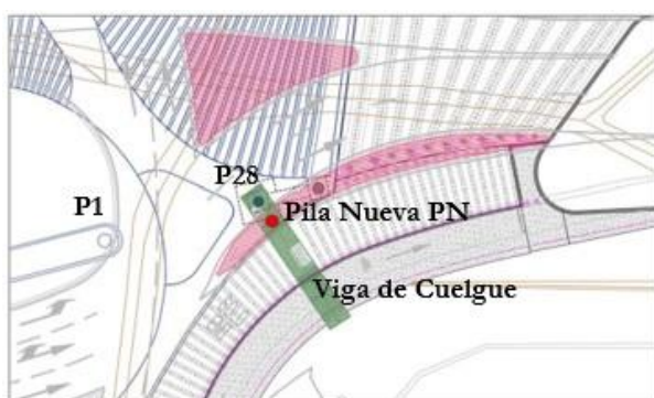
Figura 8. Planta viga de cuelgue y pilas.
