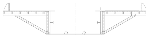
Figura 3. Estructura auxiliar para el hormigonado de los vuelos del tablero del PS-1
