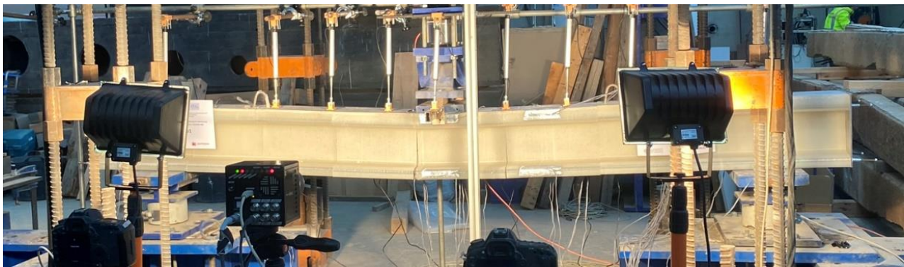
Figura 13. Imagen de la viga deformada para la carga máxima
