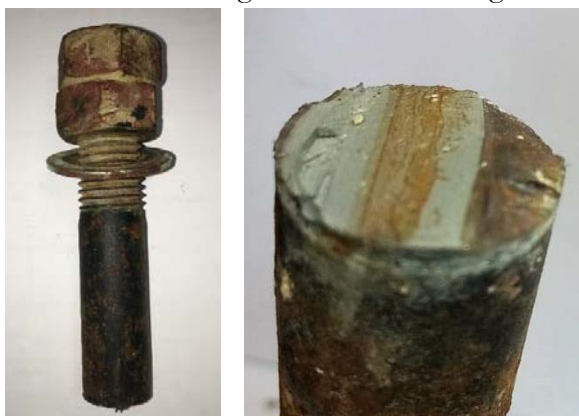
Figura 23. Vista de uno de los pernos caídos
