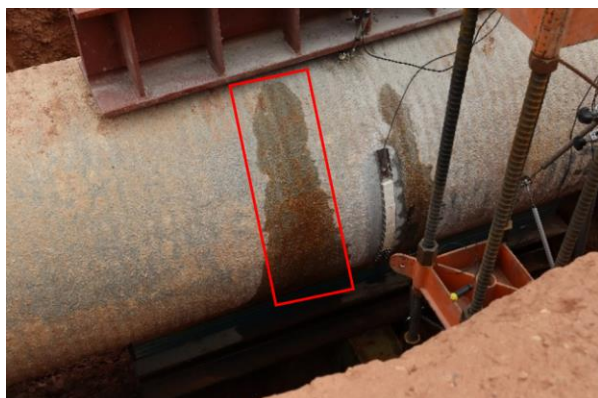
Figura 4. Fotografía del tubo al finalizar el ensayo PC-0.5 (se señala la fuga inicial).
