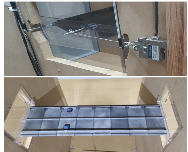
Figura 25. Ensayos en el tablero. Estático-células (arriba) y dinámico-acelerómetros (abajo).
