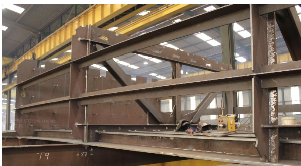
Figura 4. Fabricación de tablero en taller metálico.
