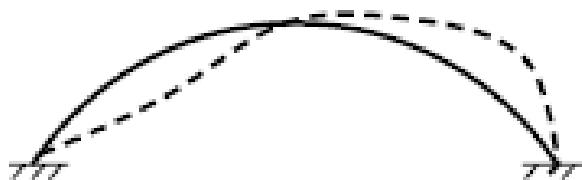
Figura 13. Modificación de directriz del arco para considerar las imperfecciones geométricas.
