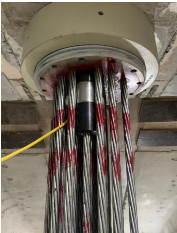
Figura 12. Escalones de carga controlados con alargamientos.
