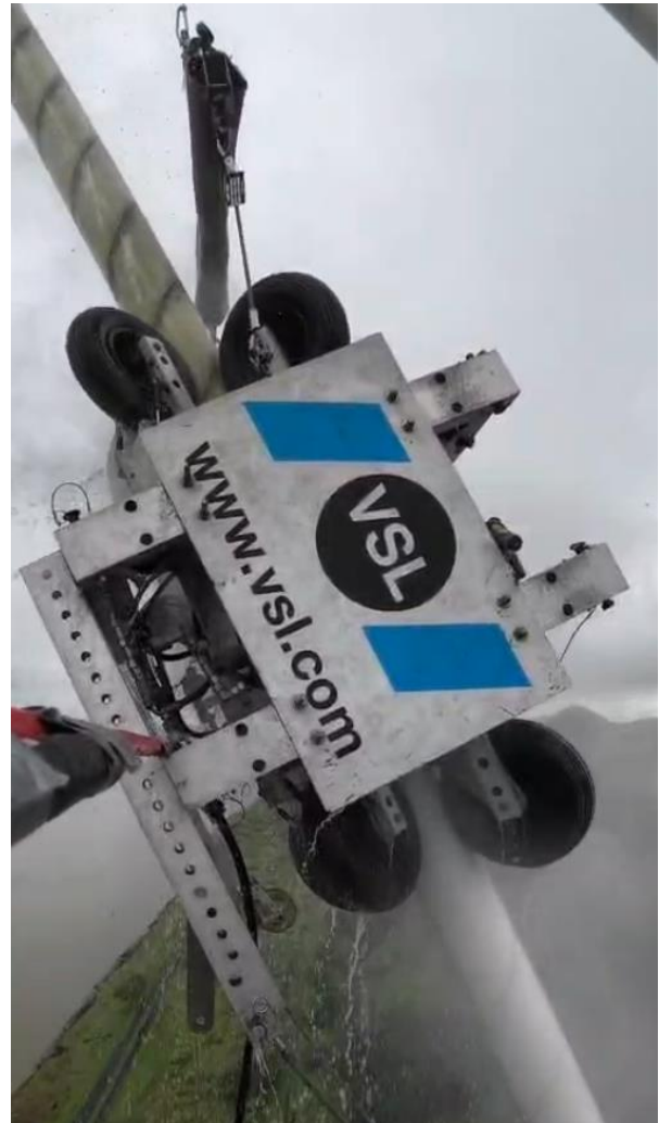
Figura 3. Robot de limpieza en acción. Foto de VSL
