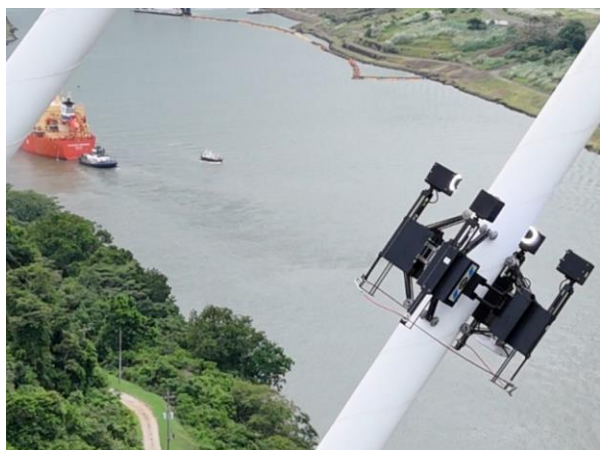
Figura 5. Robot de inspección de vainas en acción. Foto de VSL
