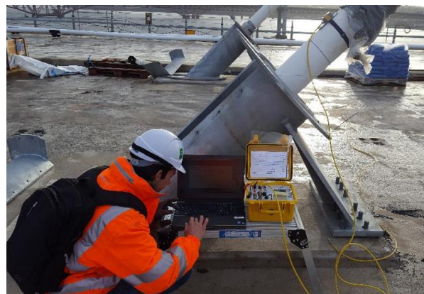
Figura 10. Toma de datos de carga usando VibraTest
