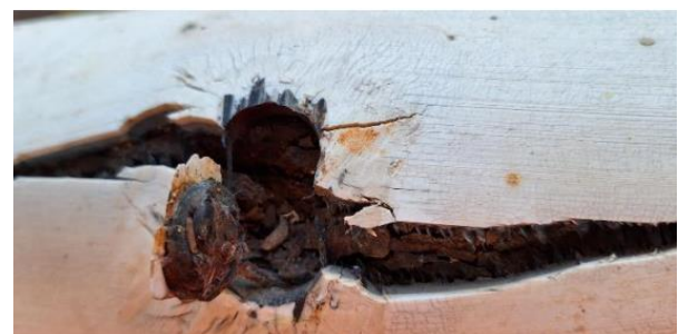
Figura 6. Fisuración de la vaina.
