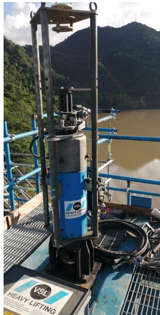
Figura 13. cilindros hidráulicos de cordones con doble anclaje activados mediante servoválvulas.
