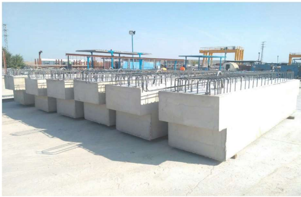
Figura 5. Vigas-cantil prefabricadas con ménsula en extremos.
