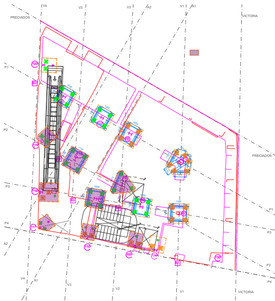
Figura 3. Cimentación de estado reformado.
