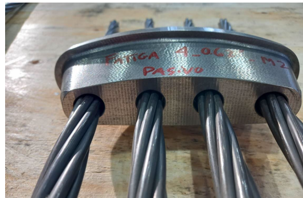
Figura 14. Placa de anclaje después de ensayo
