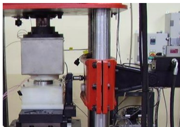
Figura 12. Probeta durante el ensayo LTFT
