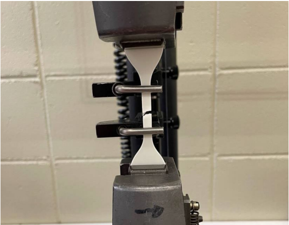
Figura 2. Ensayo según EN ISO 527-3 [5]
