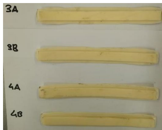
Figura 10. Muestras no alveoladas después del ensayo
