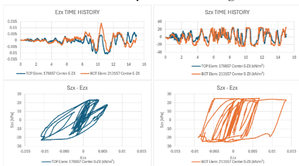
Figura 5. Degradación de la Lama del Pacífico en la zona superior (azul) y sobre la roca (naranja).
