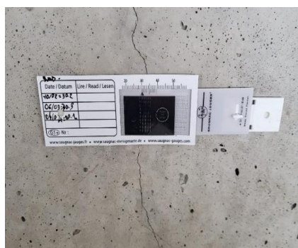
Figura 8. Fisuras en el muro de 13,6 m (a) medida de la fisura al inicio de la monitorización (b) galga uniaxial para medir la evolución del ancho de fisura.
