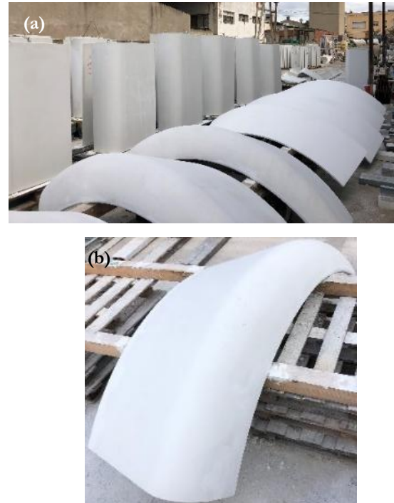
Figura 2. Vista real de los paneles de antepecho:(a) parque de acopio y (b) vista detallada.
