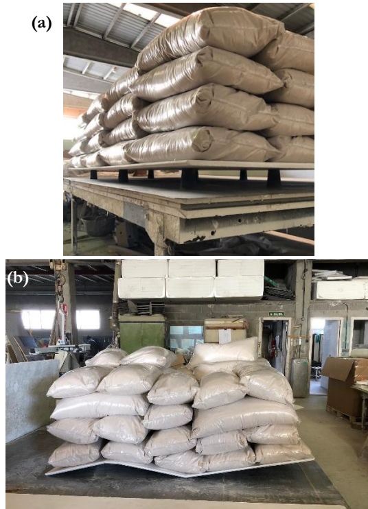
Figura 12. Configuración del ensayo de carga para los paneles de techo (a) durante el ensayo y (b) después de rotura.
