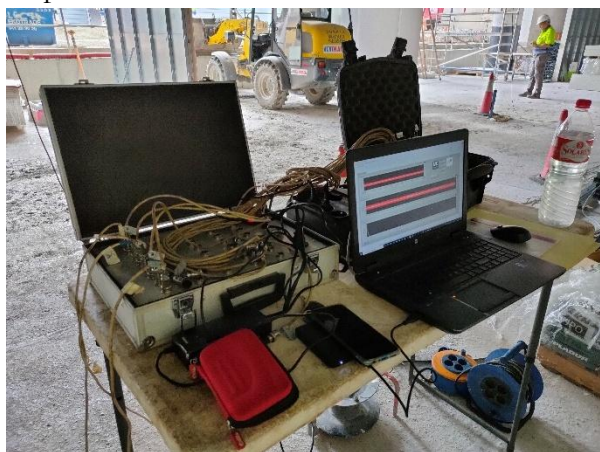
Figura 27. Foto de central de control de instrumentación durante pruebas de carga.
