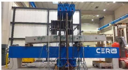
Figura 8. Ensayo a escala real del sistema de acoplamiento entre dovelas especiales.
