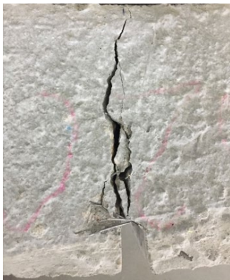
Figura 4. Probeta ensayada a flexotracción.
