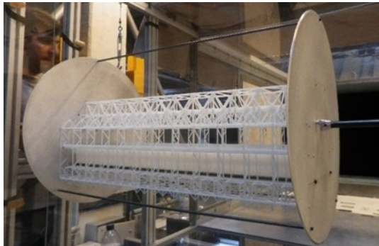
Figura 5. Modelo reducido utilizado en los testes en túnel de viento
