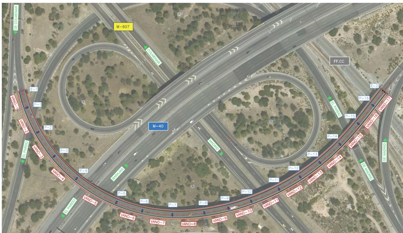
A raíz de una serie de inspecciones llevadas a cabo se tramitó una obra de emergencia que buscaba la reparación del tablero, aquejado por un proceso de degradación por reacción árido-álcali. Tras el comienzo de los trabajos se han detectado una serie de patologías ocultas en un primer momento, lo que ha llevado a modificar el alcance de la actuación y demoler el tablero existente para ejecutar uno nuevo aprovechando las pilas y cimentaciones.
