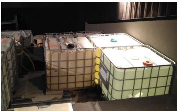
- Figura 25. Bidones de agua durante los escalones de carga
