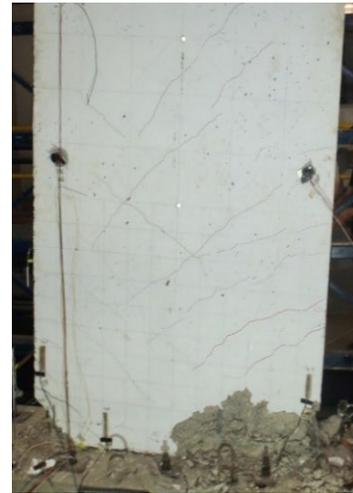
Figura 4. Estado final del muro M0R10.
